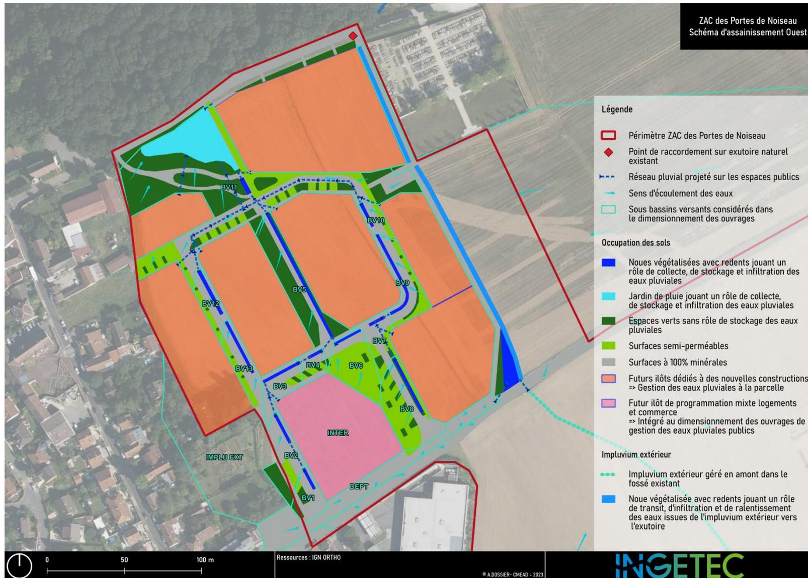
Figure 74 : Schéma d'assainissement pluvial retenu sur la partie Est de la ZAC de Portes de Noiseau
