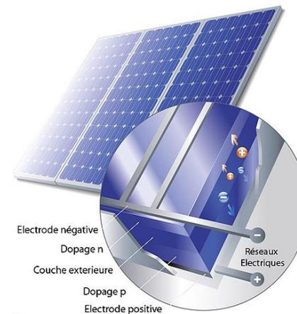
**Figure 226 : Principe de fonctionnement d'un système photovoltaïque (Source : ADEME)**
